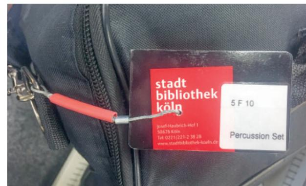
*Der RFID-Tag wird bei Instrumententaschen auf einer Karte angebracht, die vom Hausmeister mit einem Metallseil befestigt wird.*
